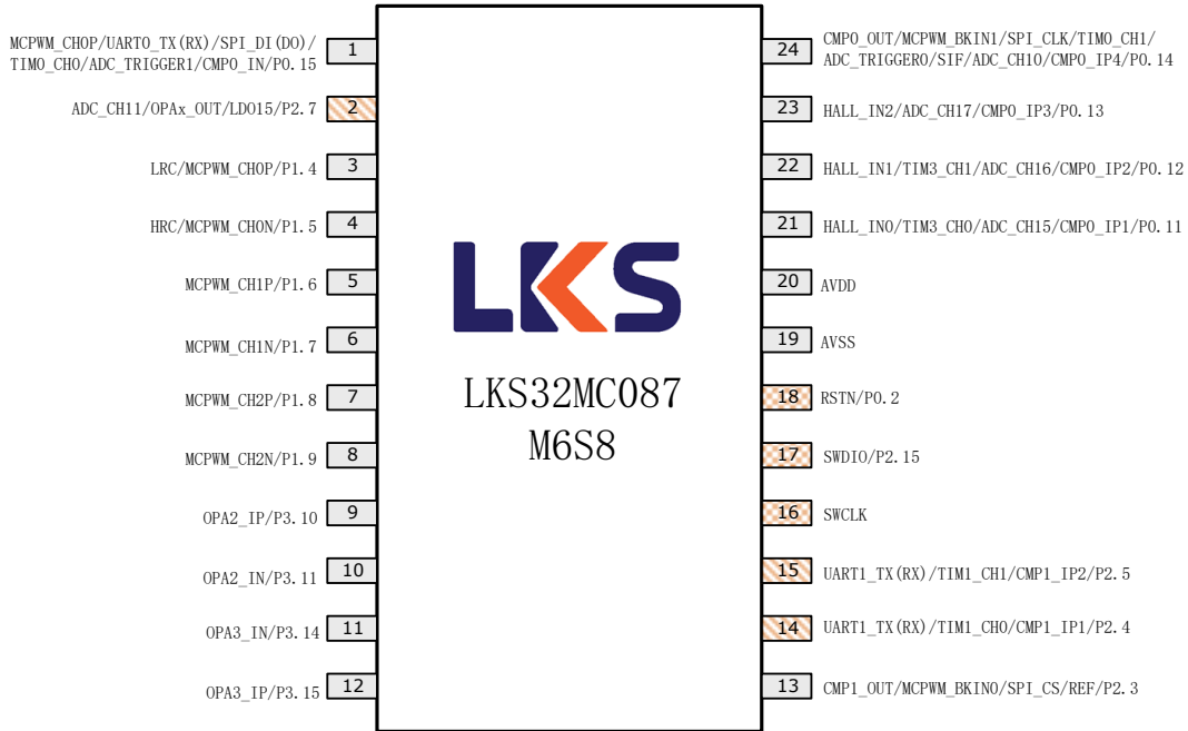
图 3-6 LKS32MC087M6S8 管脚分布图
